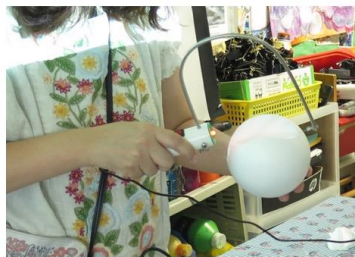
用發熱線切割發泡膠球
