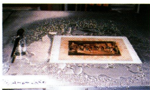
圖二 利用真空吸力檯處理版畫 Diagram 2 The lithograph under treatment on a Suction Table
