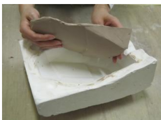
印模法: 透過模具可印壓多個一式一樣陶坯
