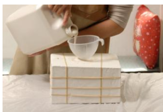
注漿法: 用泥漿注入石膏模內，待液體凝固成器型
